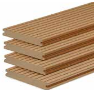
37.5652 Excellent massiv WPC 2.0x14.0x400 cm Natural Durchgängig gefärbt, 100% recyclebar, 60% Holz / 40% Kunststoff, Unterseite glatt gehobelt und Oberseite grob geriffelt
