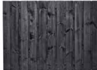
8.52130 Écran de jardin Stuttgart 130 H130x180 cm 19 planches de P1.6x14.0 cm Latte intermédiaire : P1.6x14.0 cm Pin raboté, peint en noir, Fixation avec des vis en inox
